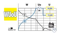
• Заряжает на 100% свинцовые АКБ с жидкостным или гелиевым электролитом (Кривая WuoU) емкостью от 20 до 150Ач.
