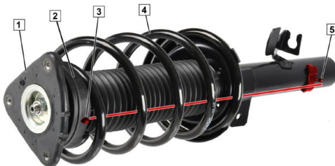
Рис. 1: Корректное размещение верхней опоры амортизационной стойки
