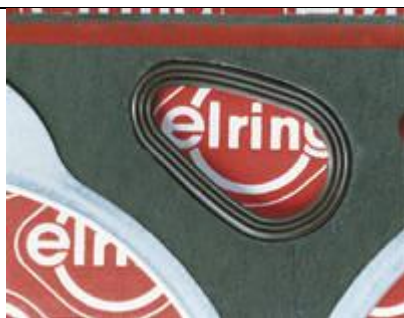
Оригинальная прокладка: точно подогнанный эластомерный профиль в зоне уплотнения масляного канала гарантирует надежность в эксплуатации
