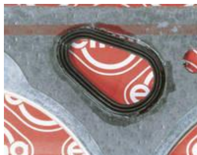
Подделка: Некачественно обработанная поверхность эластомерного профиля – возможна утечка масла.
