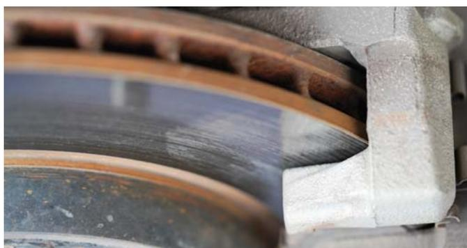
певного періоду. Якщо глибина канавки на гальмівному диску перевищує 1 мм, або якщо на поверхні гальмівного диска є тріщини, гальмівний диск необхідно терміново замінити. Важливо щоб гальмівний диск стикався з колодками максимально ефективно.
