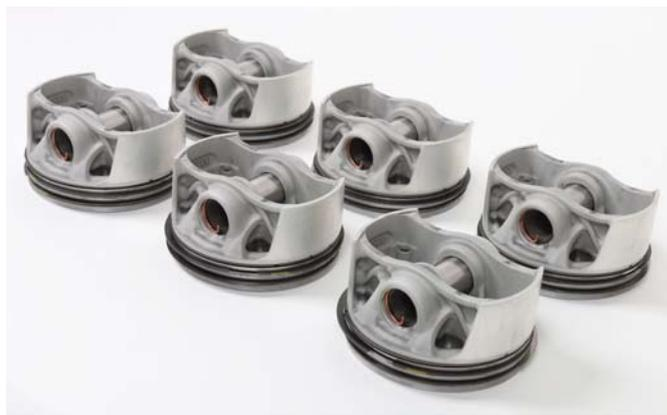
Як заявляють в Mahle, у той час, як стандартні ковані поршні вже до-сягли меж свого потенціалу в плані продуктивності, з новими деталями, надрукованими на 3D-принтері, потужність 700-сильного двигуна GT2 RS може бути збільшена приблизно на 30 к.с. при одночасному підвищенні ефективності.
