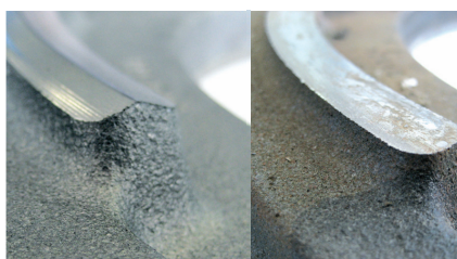
Новая и изношенная контактная линия нажимной площадки
