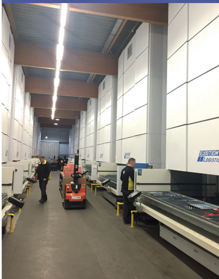
Первый этаж второй зоны склада принадлежит материнской компании Nipparts — поставщику Sator. На фото — полностью автоматизированная система хранения товара. В каждом из 16 громадных «шкафов» находится огромное количество мелких деталей, любую из которых оператор получает, просто набрав код товара в системе
