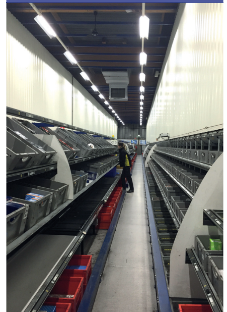
Из коридоров на предыдущем фото, запчасти попадают сюда. Робот выдает оператору ящик с товаром и указывает количество, которое нужно отобрать. Затем возвращает остаток на место хранения.
