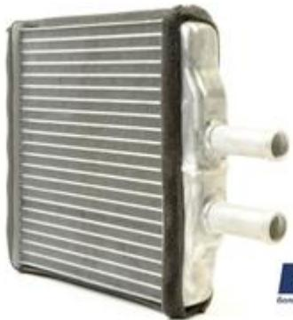
Радиаторы отопления (они же радиаторы отопителя, они же радиаторы печки) – это теплообменники, которые используют выработанное двигателем тепло для обогрева салона автомобиля. Они позволяют поддерживать комфортную температуру и исключают запотевание стекол в автомобиле.
